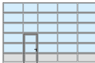
Iebūvēto durvju izvietojums kreisajā pusē
