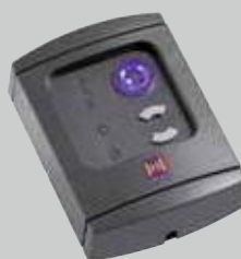
Iekšējā sensorierīce IT 3b liels, apgaismots taustiņš ērtai vārtu atvēršanai, divi papildu taustiņi piedziņas apgaismojuma darbināšanai un tālvadības funkcijas atslēgšanai, piemēram, dodoties atvaļinājumā (ierīcei SupraMatic).
